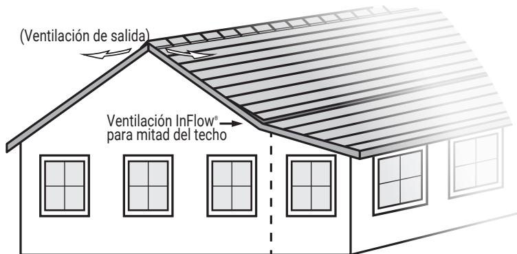
**Colocación típica de la ventilación InFlow® "a mitad del techo". Área habitable acondicionada a porche no acondicionado**
