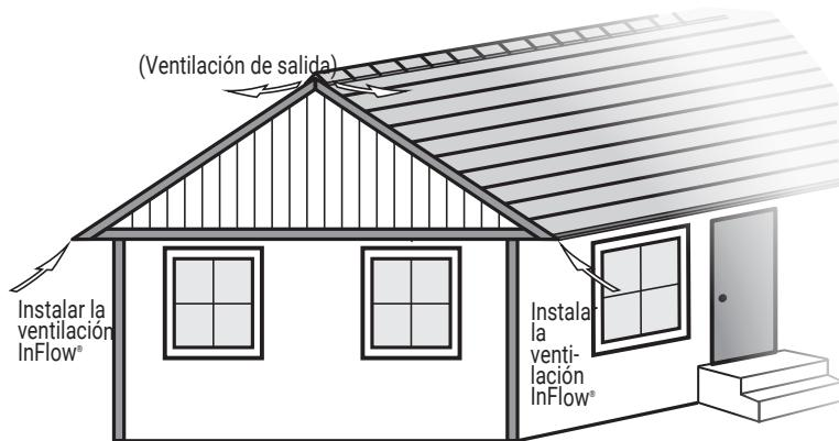
**Entrada de aire auxiliar típica de la ventilación InFlow® para aleros en casas con sofite que tienen poca ventilación o cuya entrada de aire está bloqueada**
