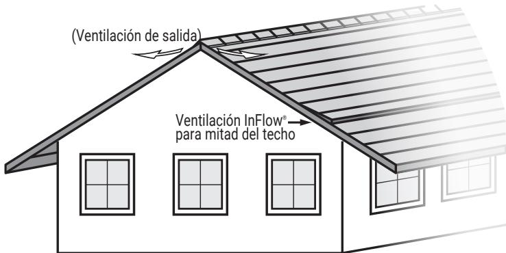
**Colocación típica de la ventilación InFlow® "a mitad del techo". Vigas expuestas o sofitos abiertos**
