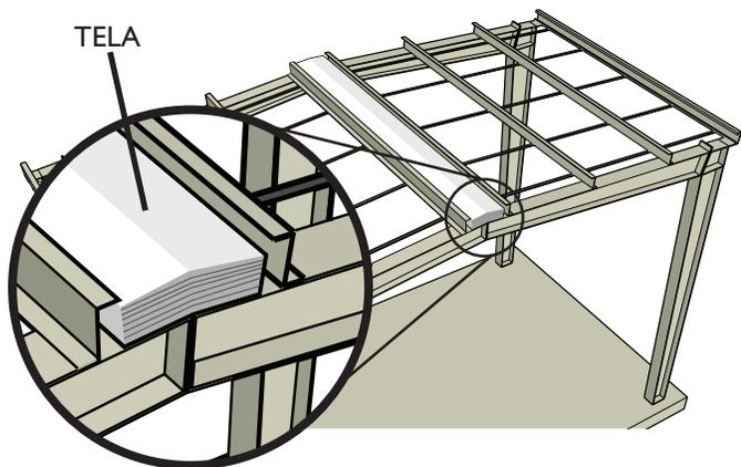
5. Alimente el borde de la tela debajo de los largueros y sobre el zunchado. Complete una mitad del bastidor en una sola vez.
