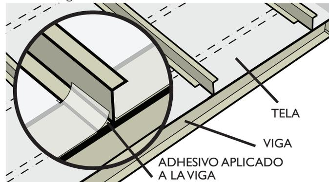
11. Usando la cinta adhesiva o bifásica suministrada, coloque la tela sobre las vigas y a los lados de los largueros.
