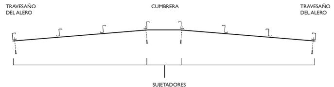
Nota: Si es necesario, use la banda longitudinal de pared final a pared final cada 25 pies para el soporte de banda transversal durante la instalación. También se pueden usar dos bandas longitudinales en el área de la cumbrera para proporcionar soporte adicional para la implementación de la tela. Quite las bandas longitudinales cuando finalice.
