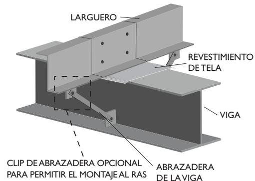
Nota: Durante el proceso de instalación asegúrese de que los bordes de la tela se sellen correctamente y estén adyacentes a las superficies para que mantengan la integridad de la barrera de vapor.
